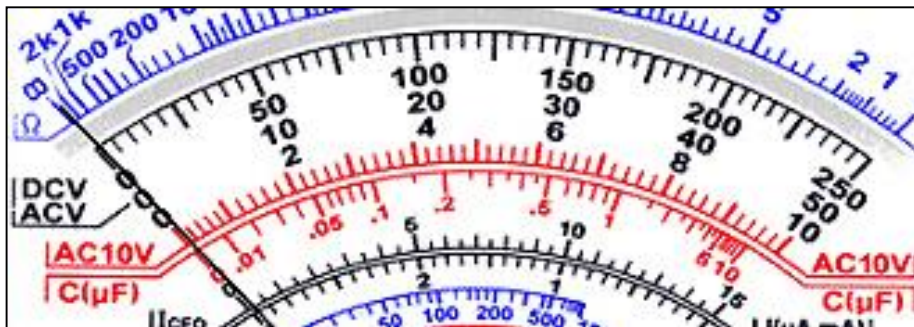
รูปที่ 1.16 การแสดงค่าวัตต์แรงดันกระแสตรงและกระแสสลับ
