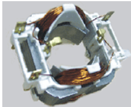
รูปที่ 1.31 ขดลวดพันอยู่รอบขั้วแม่เหล็ก
