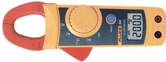
รูปที่ 1.20 ตัวอย่างเครื่องวัดชนิดคล้องสาย
